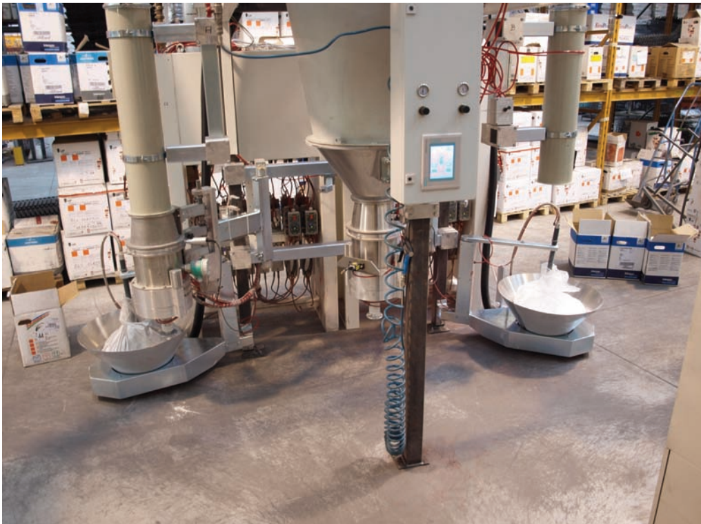
Schnellere Farbwechselsysteme unterstützen Beschichtungsbetriebe dabei, trotz kleinerer Losgrößen wirtschaftlich zu beschichten. Ein Pulvermanagement-Center erlaubt einen Farbwechsel innerhalb von 10 s. Das System basiert auf zwei Aufbereitungssystemen, die unabhängig voneinander arbeiten.
