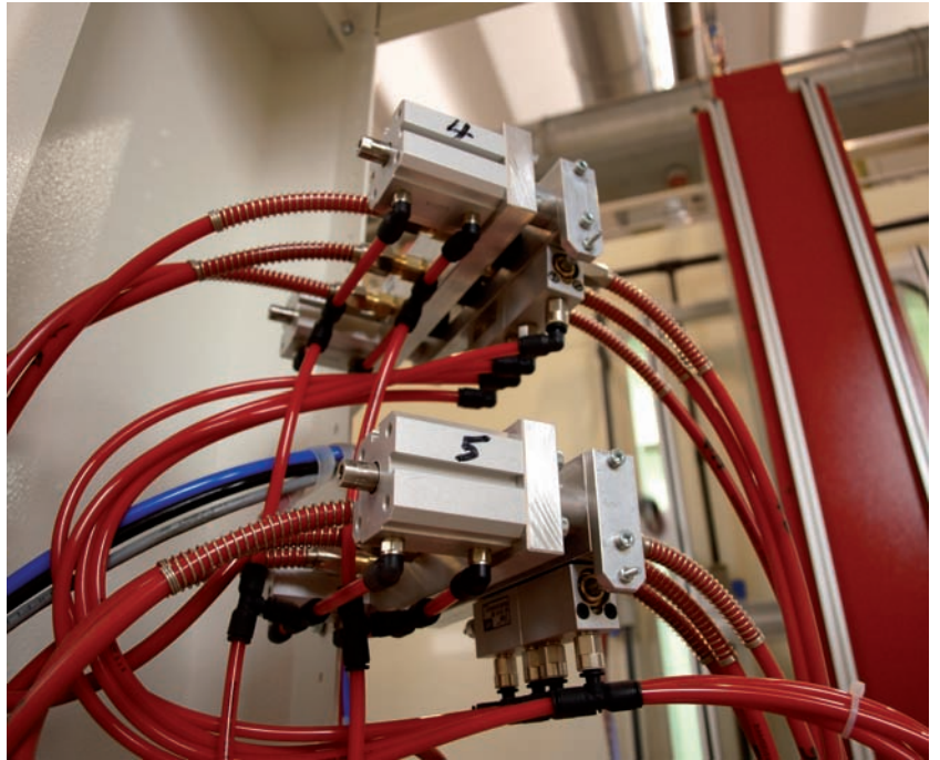
Im Tandemkonzept kommt ein spezieller Farbwechsler zum Einsatz, der auf jeder Pistole montiert ist und zwischen zwei Pulverschläuchen wechselt. Diese Anordnung erlaubt während des Prozesses, die Schläuche einschliesslich des Pulvermanagement-Centers zu entleeren und zu reinigen.
