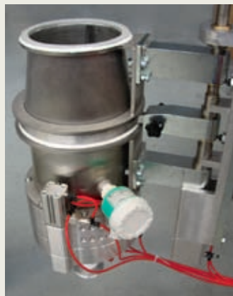
Schnellere Farbwechselsysteme unterstützen Beschichtungsbetriebe dabei, trotz kleinerer Losgrößen wirtschaftlich zu beschichten. Ein Pulvermanagementcenter erlaubt einen Farbwechsel innerhalb von zehn Sekunden. Das System basiert auf zwei Aufbereitungssystemen, die unabhängig voneinander arbeiten.
