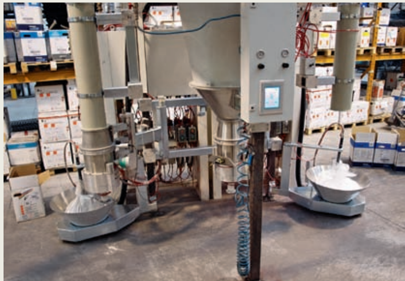
Schnellere Farbwechselsysteme unterstützen Beschichtungsbetriebe dabei, trotz kleinerer Losgrößen wirtschaftlich zu beschichten. Ein Pulvermanagementcenter erlaubt einen Farbwechsel innerhalb von zehn Sekunden. Das System basiert auf zwei Aufbereitungssystemen, die unabhängig voneinander arbeiten.
