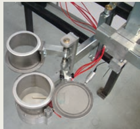
Schnellere Farbwechselsysteme unterstützen Beschichtungsbetriebe dabei, trotz kleinerer Losgrößen wirtschaftlich zu beschichten. Ein Pulvermanagementcenter erlaubt einen Farbwechsel innerhalb von zehn Sekunden. Das System basiert auf zwei Aufbereitungssystemen, die unabhängig voneinander arbeiten.
