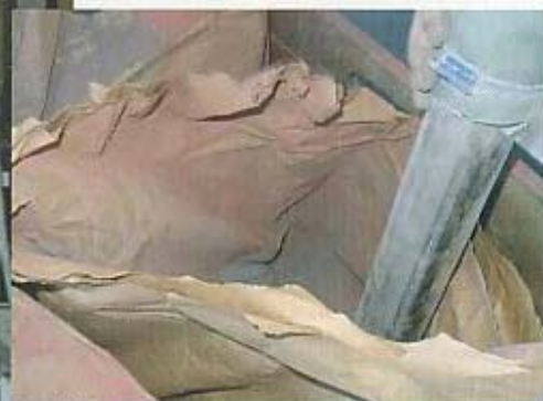
Der Umfüllvorgang aus der Nähe: kaum Staubentwicklung beim Umfüllen – der Operateur trägt trotzdem vorschriftskonform eine Maske
