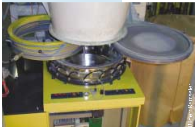
Das neue Konzept ist besonders für Kleinmengen geeignet. Hier ein Blick in das Pulvermanagement-Center mit Pulverentleerung ins Normgebinde
