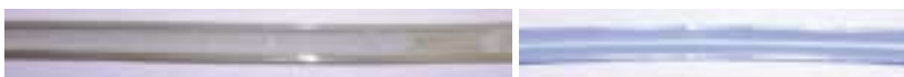
Vergleich der Verunreinigungen im Venturi-Schlauch (links) und in der DDF Transportleitung (rechts) nach jeweils 200 Stunden Produktion bei Ramseier (mit Tribo, Position unmittelbar vor der Pistole)
